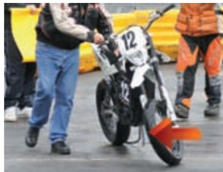
Rechts: Die Kette (Pfeil) war entweder zu stramm angezogen oder zu locker - jedenfalls riss sie noch im Rennen, was zum Sturz führte.
