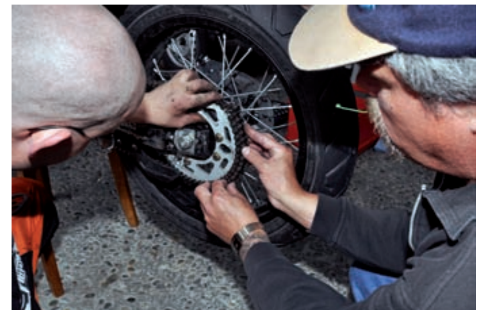
Rechts: Kette kaputt. Es fehlen 2 Zentimeter und ein neues Kettenschloss.
